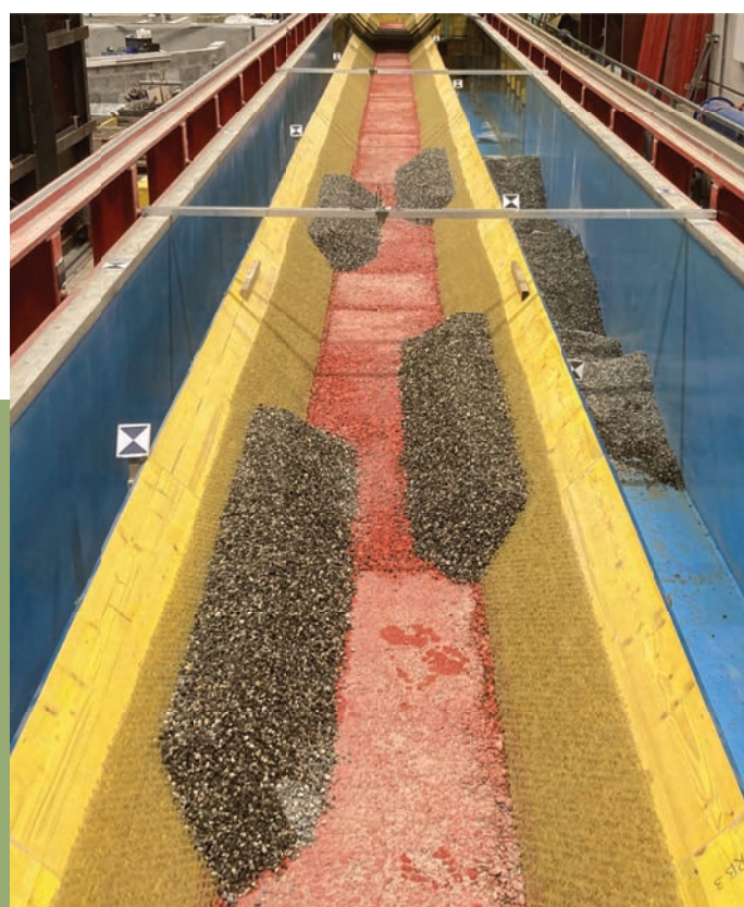
Fig. 3: Essais de modèles physiques sur l'apport de sédiments et son influence sur la morphologie subaquatique à la PL-LCH de l'EPFL (photo: Christian Mörtl).
