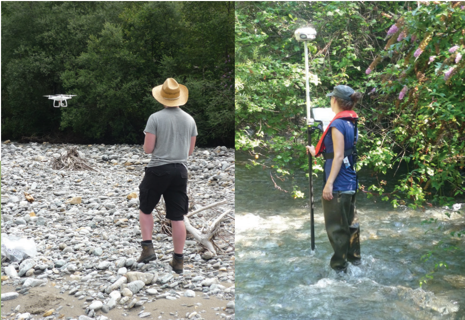
Fig. 4: Les modèles numériques sont fondés sur des relevés de données morphologiques (Moesa, GR). Les zones non immergées sont mesurées par des drones (à g.), les zones immergées au moyen d'un GPS (à d.) (photos: Sabine Fink).
