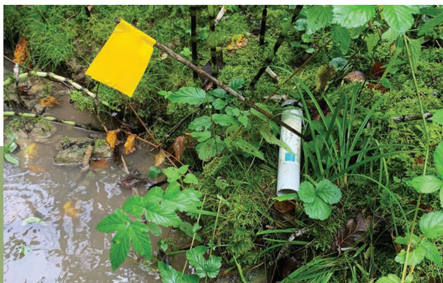
Tube à échantillons fermé d'un côté par un fin grillage et muni d'un petit drapeau (photo: Markus Plattner).
